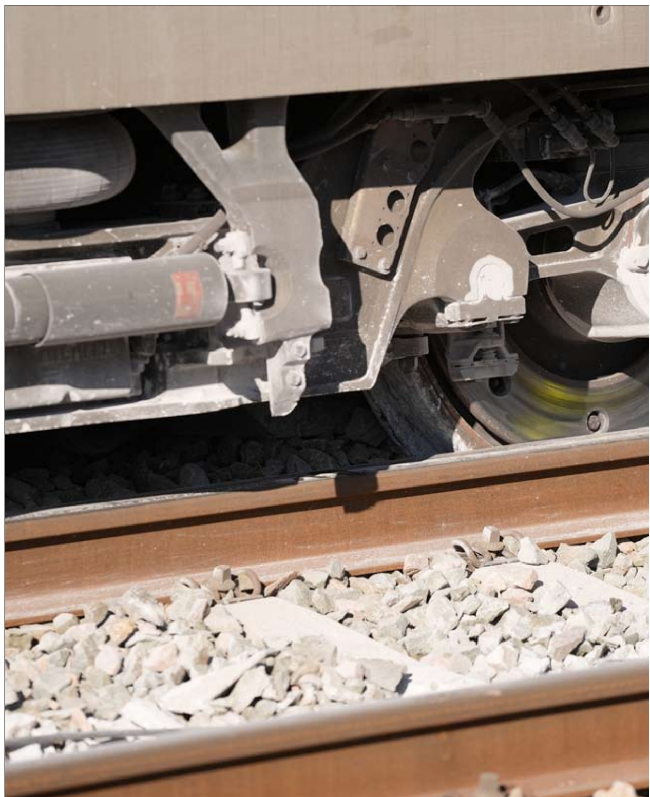
Las ruedas de uno de los vagones del tren de Iryo fuera de los carriles de la vía. / JOAQUIN CORCHERO
